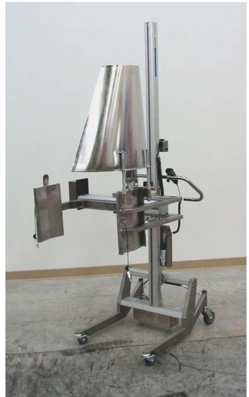
Reversible Pour Chute (Right-Hand to Left Hand Side)
